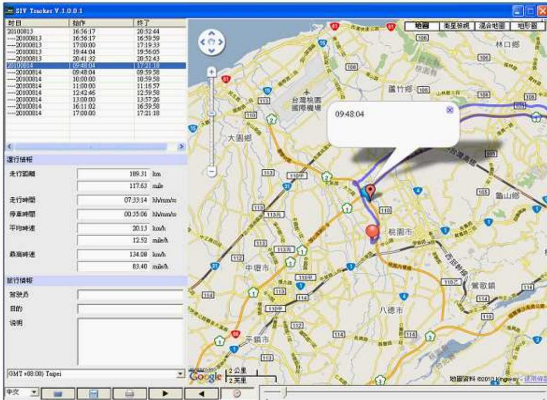
用於車輛交通管理，可紀錄行車路線、行車里程、行駛時間、中途車輛停止時間、平均車速、最高速度...等的行車紀錄。此行車管理系統，是藉由GPS衛星定位軌跡與系統整合，將一天下來的行車動線做完整紀錄。（行車紀錄最久可紀錄長達70小時數據檔案）
